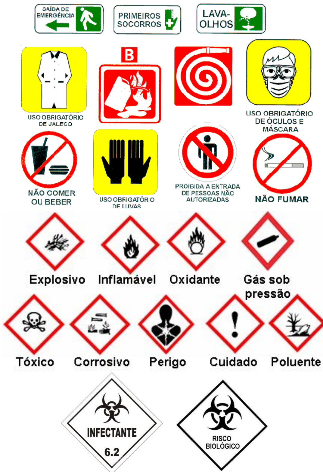
Figura 3: Sinalização em laboratórios
