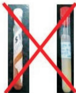
Figuras 3 e 4: Identificação inadequada
