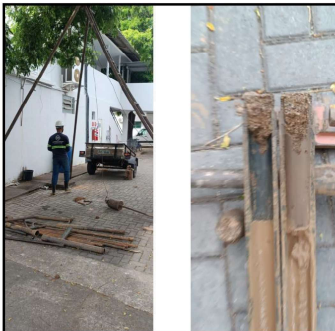
Localização do furo em SP 02 e amostra de solo obtida através do amostrador padrão
